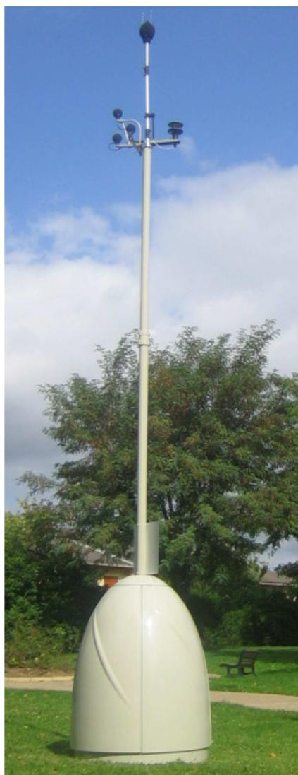
Les matériels de mesure utilisés sont des stations de type NA37 de marque Rion. Il s'agit de stations de mesure du bruit qui sont équipées d'un système de localisation de la direction de provenance du bruit. Il est ainsi possible de classer automatiquement les événements sonores selon qu'ils proviennent du ciel ou de la terre et de déterminer différents indicateurs acoustiques liés au bruit des aéronefs.
